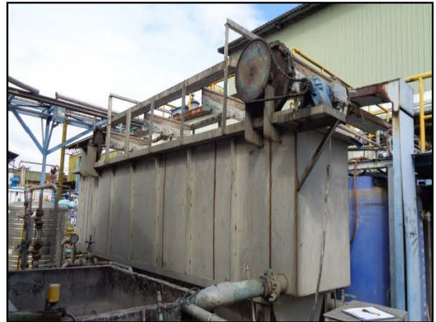
ภาพถ่ายที่ 8 ระบบบำบัดน้ำเสีย แบบ Dissolved Air Flotation (DAF)
