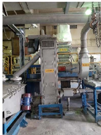
ภาพถ่ายที่ 2 พัดลมดูดอากาศ ภายในเครื่องอบแห้ง
