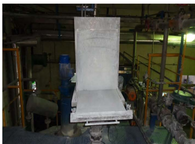
ภาพถ่ายที่ 46 ห้องครอบแบบปิดครอบคลุม จุดเติมสาร Antimony
