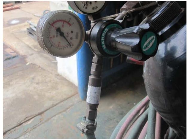
ภาพถ่ายที่ 68 อุปกรณ์ป้องกันไฟย้อนกลับ (Flashback Arrestors)
