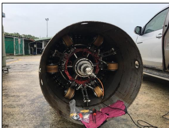
รูปที่ 2-27 การตรวจสอบการกีดกีดกันของผิวในท่อด้วยการปล่อยกระสวย (Intelligent PIG)
