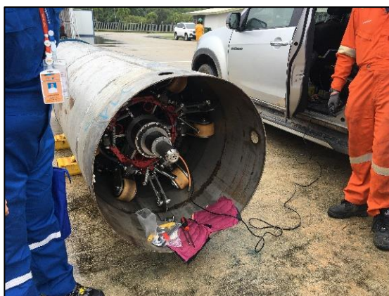
รูปที่ 2-27 การตรวจสอบการกีดกีดกันของผิวในท่อด้วยการปล่อยกระสวย (Intelligent PIG)
