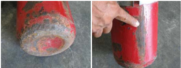
รูป 3.2 การฟุกร่อน,สนิมของตัวและก้นท่อ รูป 3.3 การเกิดรอยร้าว ปรีแตก
