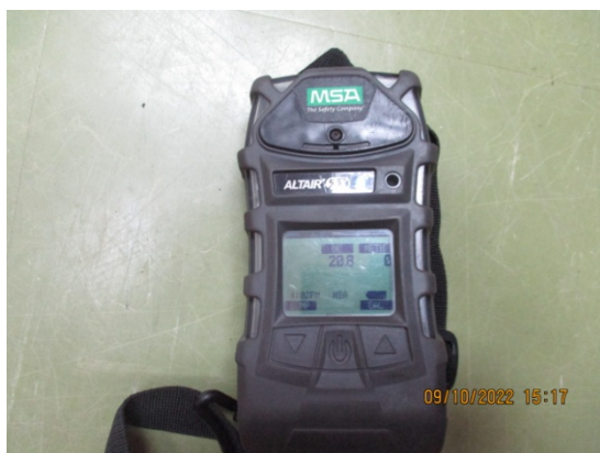
รูปที่ 3.1-2(38) เครื่องตรวจวัดก๊าซแบบเคลื่อนที่
