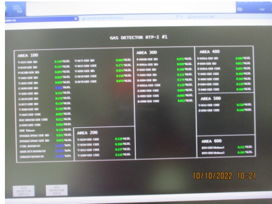
รูปที่ 3.1-2(56) หน้าจอแสดง Alarm Threshold ของเครื่องตรวจก๊าซ
