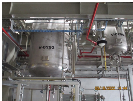
รูปที่ 3.1-2(53) ถังเก็บสารควบคุมน้ำหนัก โมเลกุล 9
