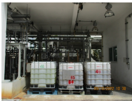
รูปที่ 3.1-2(54) ภาพขณะรองรับในการระบายของเหลวออกจากอุปกรณ์
