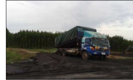
การเข้า ไร่เป็นกองในระดับต่ำป้องกันการฟุ้งกระจาย
