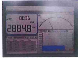
รูปที่ 14 ความเร็วรอบเครื่องยนต์ (Engine Speed) ที่อ่านค่าได้เท่ากับ 2,884.8 รอบต่อนาที (rpm.)
