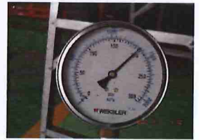
รูปที่ 6 Discharge Pressure ที่อ่านค่าได้เท่ากับ 196 psi.
