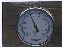
รูปที่ 23 Suction Pressure ที่อ่านค่าได้เท่ากับ 3 psi.
