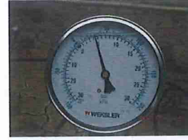
รูปที่ 19 Suction Pressure ที่อ่านค่าได้เท่ากับ 4.4 psi.
