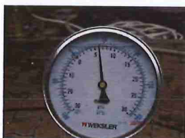
รูปที่ 7 Suction Pressure ที่อ่านค่าได้เท่ากับ 6 psi.
