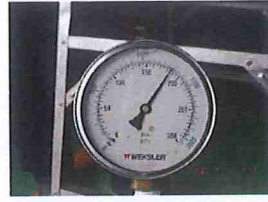
รูปที่ 16 Discharge Pressure ที่อ่านค่าได้เท่ากับ 185 psi.
