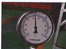
รูปที่ 13 Suction Pressure ที่อ่านค่าได้เท่ากับ 6.5 psi.
