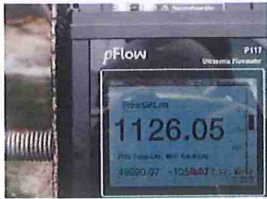
รูปที่ 13 อัตราการไหล (Flow Rate) ที่อ่านค่าได้เท่ากับ 1,126.05 แกลลอนต่อนาที (gpm.)
