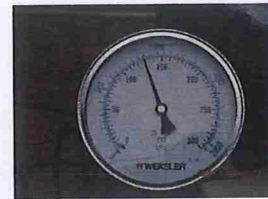
รูปที่ 24 Discharge Pressure ที่อ่านค่าได้เท่ากับ 130 psi.
