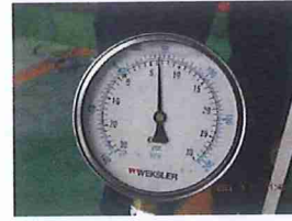
รูปที่ 19 Suction Pressure ที่อ่านค่าได้เท่ากับ 6.4 psi.
