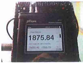
รูปที่ 13 อัตราการไหล (Flow Rate) ที่อ่านค่าได้เท่ากับ 1,875.84 แกลลอนต่อนาที (gpm.)
