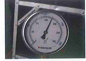
รูปที่ 20 Discharge Pressure ที่อ่านค่าได้เท่ากับ 175 psi.
