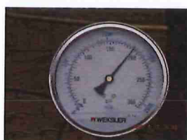
รูปที่ 8 Discharge Pressure ที่อ่านค่าได้เท่ากับ 190 psi.
