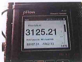
รูปที่ 21 อัตราการไหล (Flow Rate) ที่อ่านค่าได้เท่ากับ 3,125.21 แกลลอนต่อนาที (gpm.)
