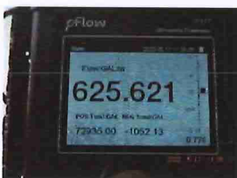
รูปที่ 7 อัตราการไหล (Flow Rate) ที่อ่านค่าได้เท่ากับ 625.621 แกลลอนต่อนาที (gpm.)
