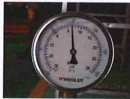
รูปที่ 5 Suction Pressure ที่อ่านค่าได้เท่ากับ 6.5 psi.
