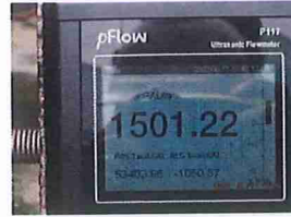
รูปที่ 17 อัตราการไหล (Flow Rate) ที่อ่านค่าได้เท่ากับ 1,501.22 แกลลอนต่อนาที (gpm.)
