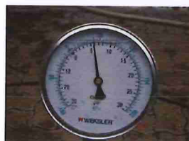
รูปที่ 11 Suction Pressure ที่อ่านค่าได้เท่ากับ 5.8 psi.
