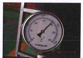
รูปที่ 14 Discharge Pressure ที่อ่านค่าได้เท่ากับ 192 psi.
