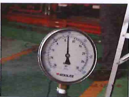
รูปที่ 9 Suction Pressure ที่อ่านค่าได้เท่ากับ 6.5 psi.
