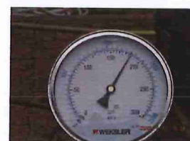
รูปที่ 12 Discharge Pressure ที่อ่านค่าได้เท่ากับ 183 psi.
