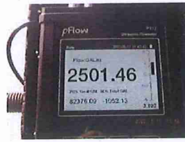
รูปที่ 17 อัตราการไหล (Flow Rate) ที่อ่านค่าได้เท่ากับ 2,501.46 แกลลอนต่อนาที (gpm.)
