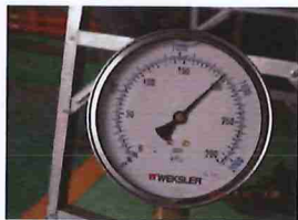
รูปที่ 10 Discharge Pressure ที่อ่านค่าได้เท่ากับ 195 psi.
