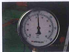
รูปที่ 23 Suction Pressure ที่อ่านค่าได้เท่ากับ 6.2 psi.
