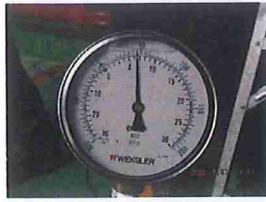
รูปที่ 15 Suction Pressure ที่อ่านค่าได้เท่ากับ 6.5 psi.
