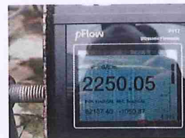
รูปที่ 25 อัตราการไหล (Flow Rate) ที่อ่านค่าได้เท่ากับ 2,250.05 แกลลอนต่อนาที (gpm.)
