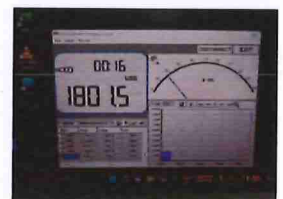
รูปที่ 12 ความเร็วรอบเครื่องยนต์ (Engine Speed) ที่อ่านค่าได้เท่ากับ 1,801.5 รอบต่อนาที (rpm.)
