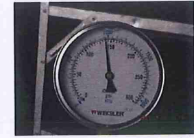
รูปที่ 28 Discharge Pressure ที่อ่านค่าได้เท่ากับ 140 psi.
