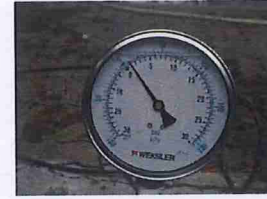
รูปที่ 27 Suction Pressure ที่อ่านค่าได้เท่ากับ 1 psi.
