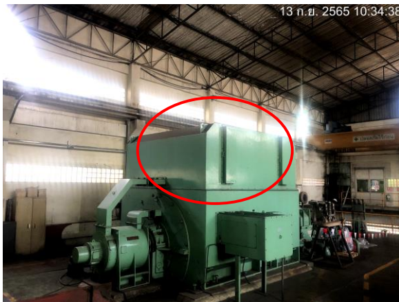
รูปที่ 21 การปิดครอบเครื่องจักรอุปกรณ์ที่มีเสียงดัง
