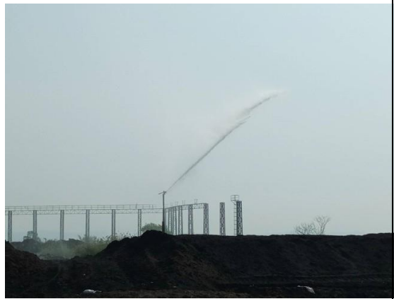
รูปที่ 13 การฉีดพรมน้ำ บริเวณกองเถ้า
