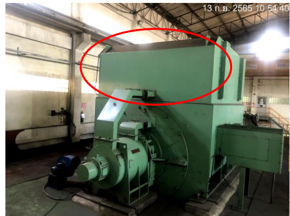
รูปที่ 21 การปิดครอบเครื่องจักรอุปกรณ์ที่มีเสียงดัง
