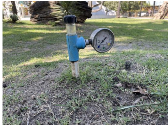
รูปที่ 129 การติดตั้งเครื่อง Tensiometer วัดความชื้นของดิน
