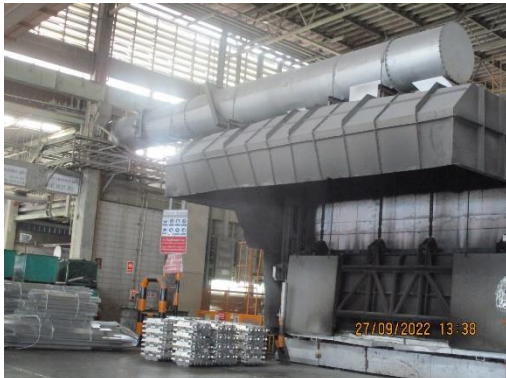
Hood ดูดอากาศบริเวณหน้าเตาหลอม
