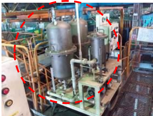
รูปที่ 16 การนำน้ำมันไฮดรอลิกที่ใช้แล้วมากลับมาใช้ใหม่ (ใส่เครื่องจักร)
