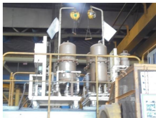
รูปที่ 16 การนำน้ำมันไฮดรอลิกที่ใช้แล้วมากลับมาใช้ใหม่ (ใส่เครื่องจักร)
