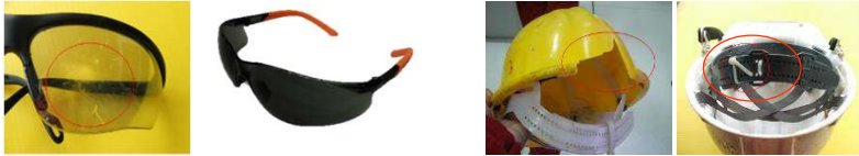
PPE ที่ไม่ได้มาตรฐาน และ ไม่ควรนำมาใช้ปฏิบัติงาน
