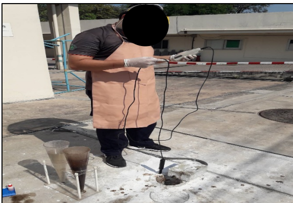
รูปที่ 2.2-24 การเก็บตัวอย่างน้ำเพื่อทำการวิเคราะห์คุณภาพน้ำทิ้ง (ต่อ)
