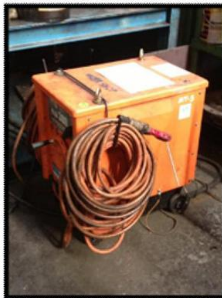
6.3.7 โคร่งตุ้เชื่อมต้องไม่ชำรุด บิดเบี้ยว สภาพแข็งแรง
