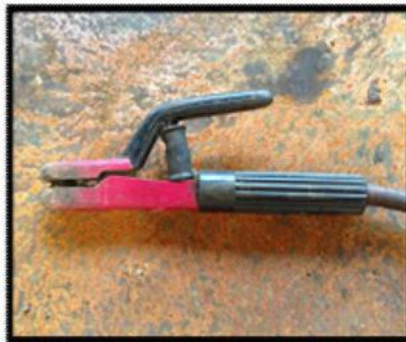
6.3.7 โคร่งตุ้เชื่อมต้องไม่ชำรุด บิดเบี้ยว สภาพแข็งแรง
