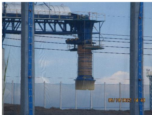
รูปที่ 26 ครอบกันฝุ่นฟุ้งกระจาย
