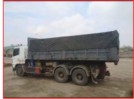
ภาพที่ 2.2-13 การปิดคลุมรถบรรทุก
