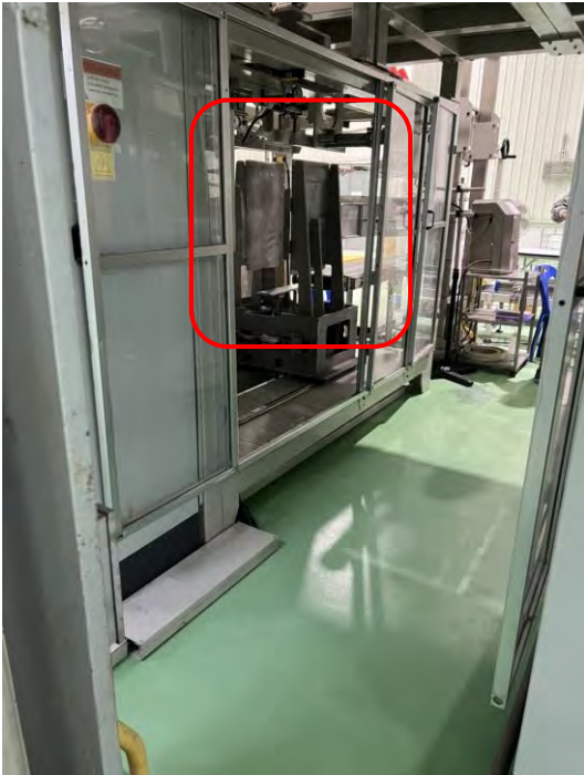
ตำแหน่งที่กระสอบน้ำตาล เข้าไปติดสายพาน infeed
