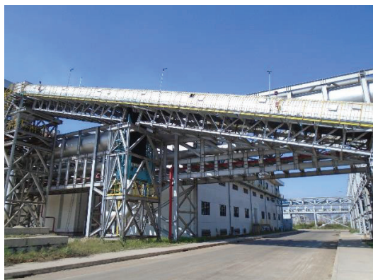
ภาพที่ 2-17 สายพานลำเลียงกากตะกอนหม้อกรองและถ้ำแบบปิด
