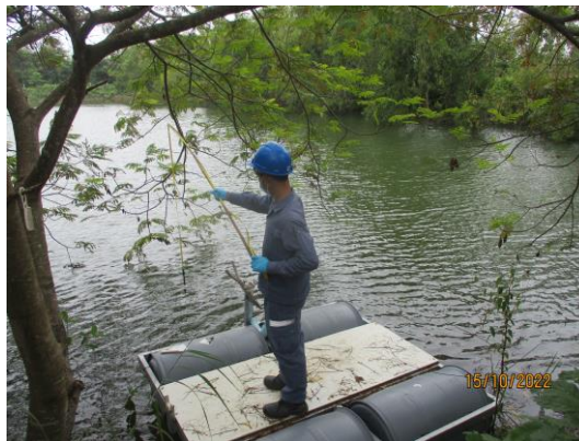
รูปที่ 3.4-2 การตรวจวัดระดับความลึกบ่อน้ำต้น
