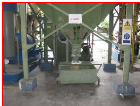
ภาพที่ 2.2-5 ระบบบำบัดแบบถุงกรอง (ระบบหลัก)
