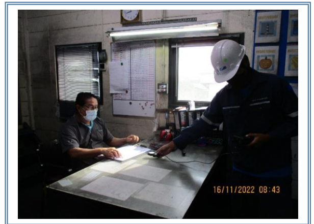
รูปที่ 4-45 แสดงการตรวจวัดความเข้มข้นของแสงสว่าง ห้องควบคุม Furnace โต๊ะทำงานคุณเกษม หอมกลิ่นคล้าย ตรวจวัดในวันที่ 16 พฤศจิกายน 2565
