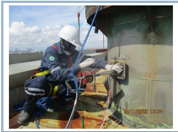
รูปที่ 4-34 แสดงการตรวจวัดปริมาณสารเจือปนในอากาศ ที่ระบายออกจากปล่องระบายเตาหลอม เก็บตัวอย่างในวันที่ 15 พฤศจิกายน 2565
