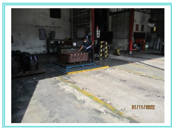
รูปที่ 3-10 ที่ซังน้ำหนักควบคุมรถบรรทุกไม่ให้เกินพิกัด
