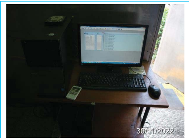
รูปที่ 3-6 คอมพิวเตอร์แสดงข้อมูลผลการตรวจวัดจากอุปกรณ์ตรวจวัดก๊าซแบบอัตโนมัติ (CEMs)
