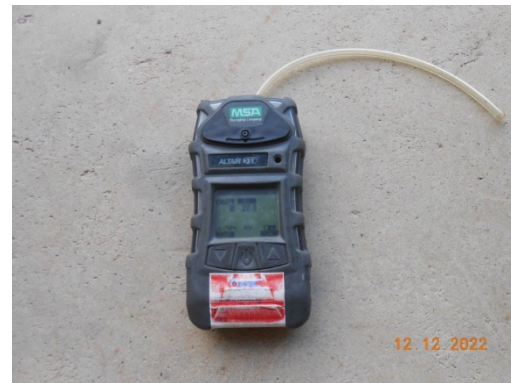
รูปที่ 52 Combustible Gas Detector
