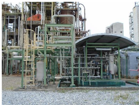
ภาพที่ 2-5 หน่วยนำกลับไอสารไฮโดรคาร์บอน (VOC Recovery Unit: VRU) ของโรงงานที่ 2
