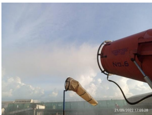
รูปที่ 16 การฟ่นละอองน้ำเพื่อลดฝุ่นจากลานกองเก็บเชื้อเพลิง
