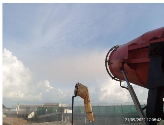
รูปที่ 16 การฟ่นละอองน้ำเพื่อลดฝุ่นจากลานกองเก็บเชื้อเพลิง
