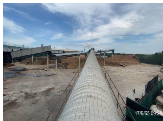
รูปที่ 8 ระบบสายพานลำเลียงเชื้อเพลิงแบบปิด
