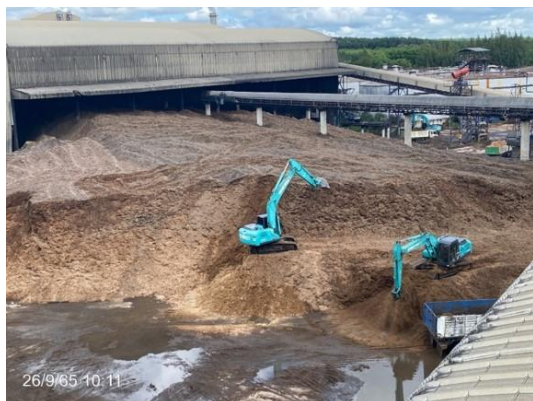
รูปที่ 13 การบดอัดเชื้อเพลิง
