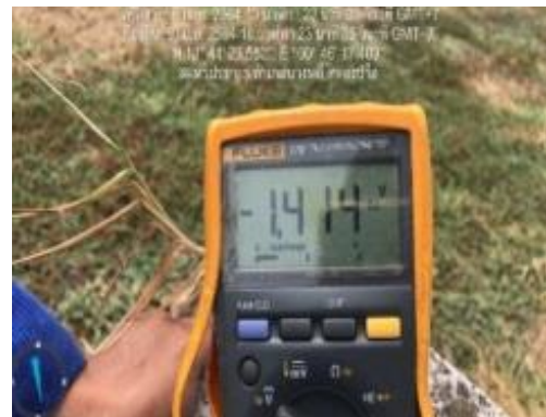
รูปที่ 2-13 (ต่อ) งานบำรุงรักษา Cathodic Protection
