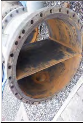
Pic. No. 8 Location : Channel (Internal) Description : สภาพโดยรวมของ Channel เป็นปกติ ไม่พบความเสียหาย
