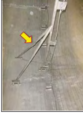
Pic. No. 27 Location : Flexible Thermocouples Description : สกปรกโดยรวมของ Flexible Thermocouples เป็นปกติ ไม่พบความเสียหาย
