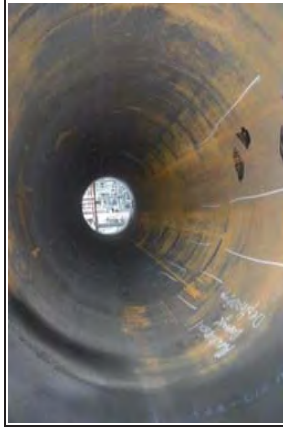
Pic. No. 11 Location : Shell (Internal) Description : พบ Mechanical Damage จากการวิ่ง Tube bundle ที่ Shell Max. Depth = 0.5 mm.
