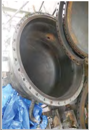
Pic. No. 14 Location : Shell Cover (Internal) Description : สภาพโดยรวมของ Shell cover เป็นปกติ ไม่พบความเสียหาย
