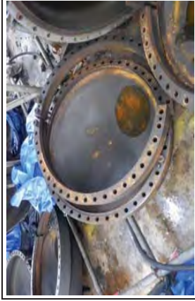
Pic. No. 15 Location : Floating Head Cover Description : สภาพโดยรวมของ Floating head เป็นปกติ ไม่พบความเสียหาย
