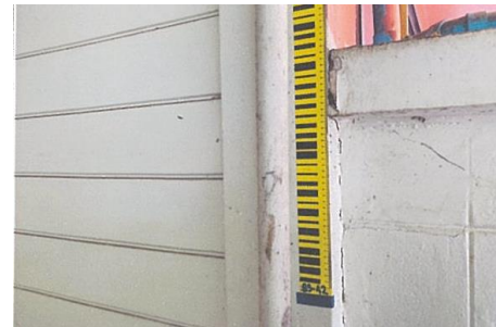
หมุดวัดการทรุดตัวของอาคาร BS42
