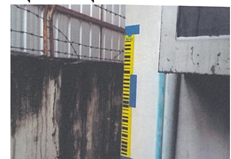
หมุดวัดการทรุดตัวของอาคาร BS21
