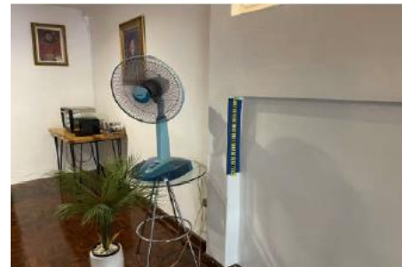
หมุดวัดการทรุดตัวของอาคาร BS56
