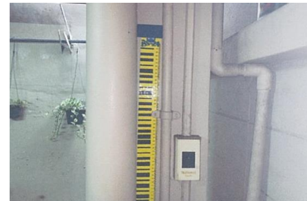
หมุดวัดการทรุดตัวของอาคาร BS24
