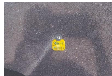
หมุดวัดการทรุดตัวของพื้น GS1
