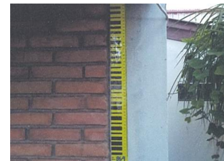
หมุดวัดการทรุดตัวของอาคาร BS9
