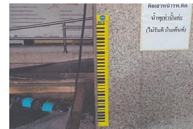
หมุดวัดการทรุดตัวของอาคาร BS1
