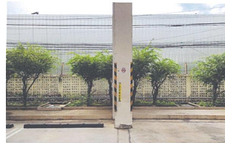
หมุดวัดการทรุดตัวของอาคาร BS49
