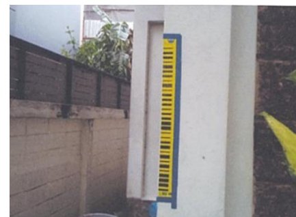
หมุดวัดการทรุดตัวของอาคาร BS14
