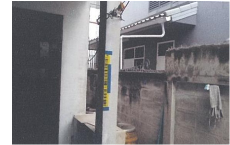
หมุดวัดการทรุดตัวของอาคาร BS19
