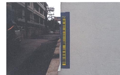
หมุดวัดการทรุดตัวของอาคาร BS4
