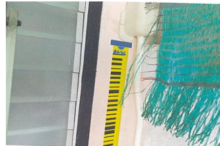
หมุดวัดการทรุดตัวของอาคาร BS36
