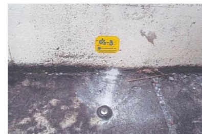
หมุดวัดการทรุดตัวของพื้น GS3
