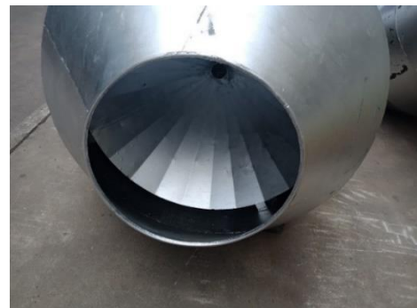
ภาพที่ 2-36 ติดตั้งระบบป้องกันน้ำฝนบริเวณปลายปล่อง
