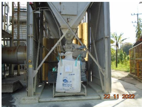
ภาพที่ 2-1 ระบบรวบรวมฝุ่นแบบ Canopy hood
