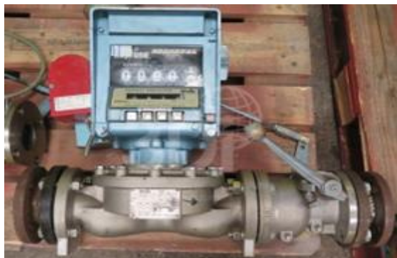
รูปที่ 1 Flowmeter พร้อมสำหรับการสอบเทียบ
