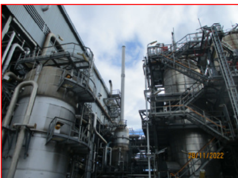
(7) Scrubber และ Condenser บริเวณ Vent Scrubber
