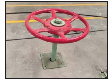
16. เปิดวาล์วไอดีครั้งแรกเข้าเครื่อง 3-5 รอบ
