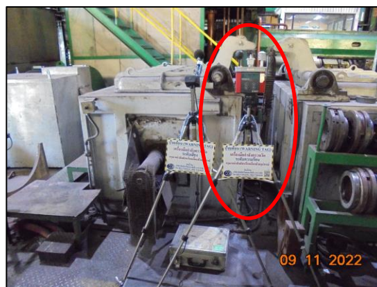
รูปที่ 3.22 การตรวจวัดระดับความร้อนในพื้นที่ทำงาน บริเวณ เครื่องอัดรีดร้อน
