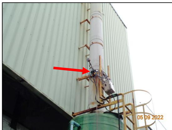
รูปที่ 3.4 การเก็บตัวอย่างคุณภาพอากาศในปล่องระบาย บริเวณ ปล่อง Wet Scrubber No.1 (เฉพาะหน่วยชุบดีบุกเท่านั้น)
