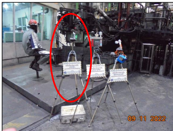
รูปที่ 3.18 การตรวจวัดระดับเสียงในพื้นที่ทำงาน บริเวณ เตาหลอม
