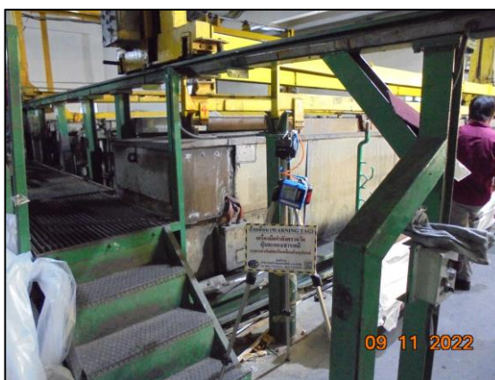
รูปที่ 3.16 การตรวจวัดคุณภาพอากาศในพื้นที่ทำงาน บริเวณ หน่วยชุบดีบุก
