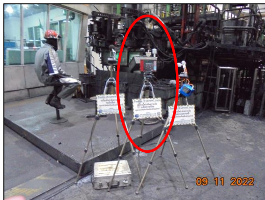
รูปที่ 3.21 การตรวจวัดระดับความร้อนในพื้นที่ทำงาน บริเวณ เตาหลอม
