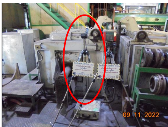
รูปที่ 3.20 การตรวจวัดระดับเสียงในพื้นที่ทำงาน บริเวณ เครื่องอัดรีดร้อน
