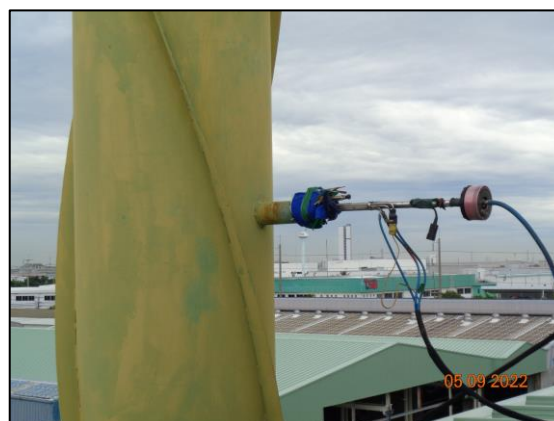
รูปที่ 3.3 การเก็บตัวอย่างคุณภาพอากาศในปล่องระบาย บริเวณ ปล่องระบายไอร้อน จากเตาอบท่อนทองแดง
