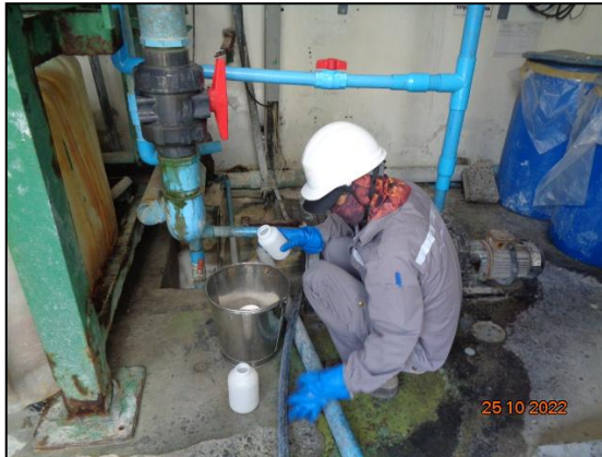
รูปที่ 3.11 การเก็บตัวอย่างคุณภาพน้ำเสียจากกระบวนการผลิต บริเวณ น้ำก่อนเข้าระบบบำบัดน้ำเสียทางเคมี
