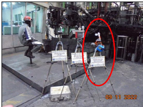
รูปที่ 3.14 การตรวจวัดคุณภาพอากาศในพื้นที่ทำงาน บริเวณ หน่วยหลอมทองแดง
