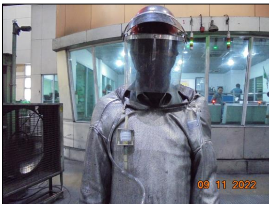
รูปที่ 3.15 ตรวจวัดคุณภาพอากาศพนักงานที่ปฏิบัติงานในพื้นที่ทำงาน บริเวณ หน่วยหลอมทองแดง
