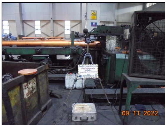
รูปที่ 3.19 การตรวจวัดระดับเสียงในพื้นที่ทำงาน บริเวณ เครื่องตัดท่อนทองแดง
