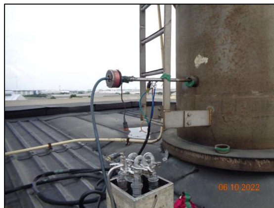
รูปที่ 3.2 การเก็บตัวอย่างคุณภาพอากาศในปล่องระบาย บริเวณ ปล่องระบายไอร้อนจากเตาหลอม
