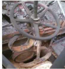
รูปที่ 3 Line blind หลังเกิดเหตุการณ์
