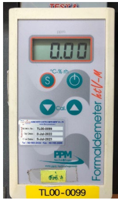
ภาพที่ 2-6 เครื่องมือตรวจวัดสารฟอร์มัลดีไฮด์แบบมือถือ
