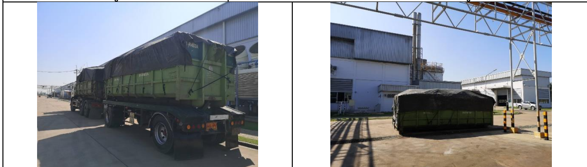
รูปที่ 2-50 การปิดคลุมของรถขนส่งกากของเสีย
