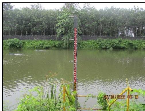
ภาพที่ 2.2 สระน้ำขนาด 200,000 ลูกบาศก์เมตรและมาตรวัดระดับน้ำ
