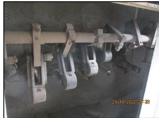
ภาพที่ 2.6 Casing หุ้มชุด Hammering Equipment
