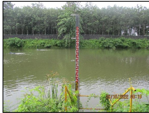
ภาพที่ 2.8 สระน้ำขนาด 200,000 ลูกบาศก์เมตรและมาตรวัดระดับน้ำ
