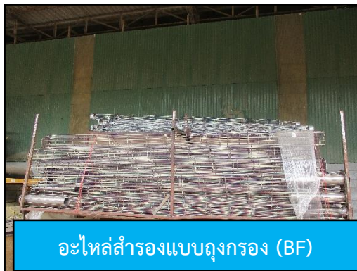
ภาพที่ 2.4 Stock อุปกรณ์/อะไหล่สำรองของระบบบำบัดมลพิษอากาศ
