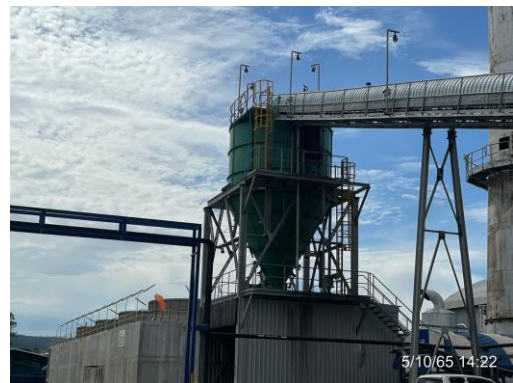
รูปที่ 17 สายพานลำเลียงเข้าแบบปิดครอบ
