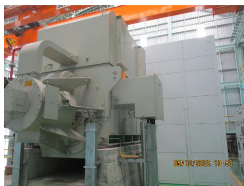
รูปที่ 26 การปิดครอบเครื่องจักรที่มีเสียงดัง
