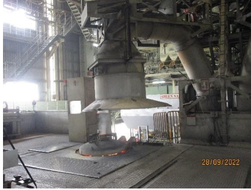
รูปที่ 1 Canopy Hood โรงงานเหล็กหล่อเสื้อสูบ
