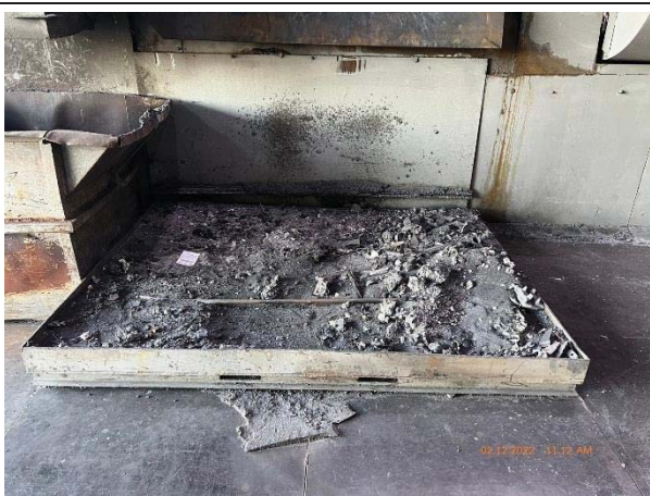
ภาพที่ 45 บ่อสำรองอุกเขินใต้เตาหลอม
