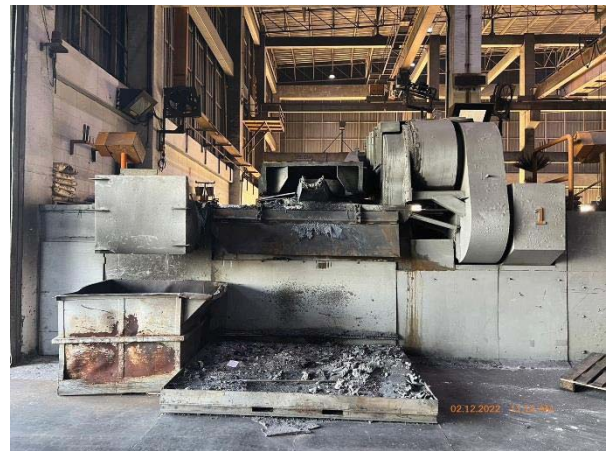
ภาพที่ 10 เตาหลอมแบบเหนียวนำไฟฟ้า
