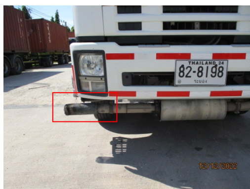
รูปที่ 3-48 อุปกรณ์ป้องกันประกายไฟที่ท่อไอเสีย
