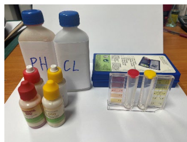
ภาพที่ 2-12 เครื่องมือตรวจวัดน้ำสระว่ายน้ำ (pH, \text{Cl}_2 )
