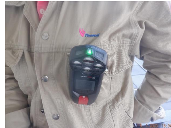
รูปที่ 2-11 การติดเครื่องเฝ้าระวังสารประกอบไฮโดรคาร์บอนส่วนบุคคล เวลาเข้าปฏิบัติงานหน้าท่าเทียบเรือ
