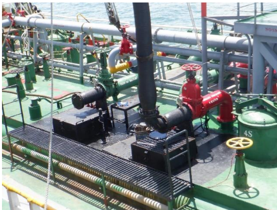
รูปที่ 2-19 ถาดรองรับน้ำมันที่อาจรั่วจากการต่อเชื่อมท่อสูบลำ
