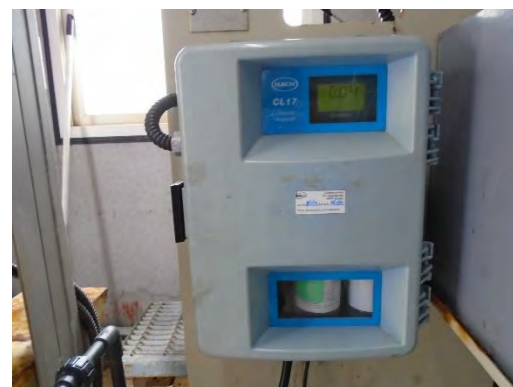
ภาพที่ 2-42 เครื่องตรวจวัดความเข้มข้นของคลอรีนในน้ำทิ้ง
