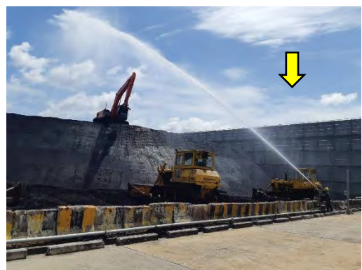
ภาพที่ 2-11 หัวฉีดพ่นน้ำ (Sprinkler) และ การฉีดพ่นน้ำบนกองถ่านหิน
