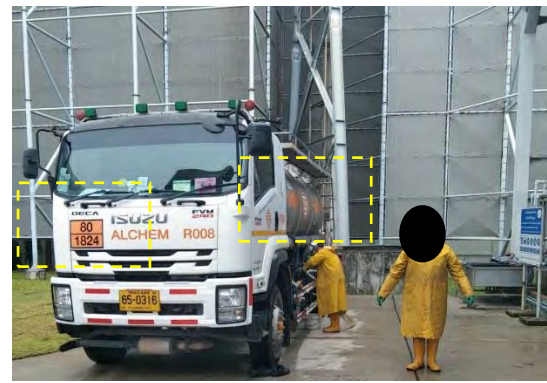
ภาพที่ 2-51 ป้ายแสดงความเสี่ยงภัย บริเวณตัวถังของรถบรรทุกสารเคมี
