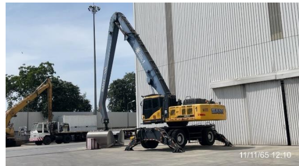
รูปที่ 17 การขนถ่ายสินค้าด้วย Mobile Grab
