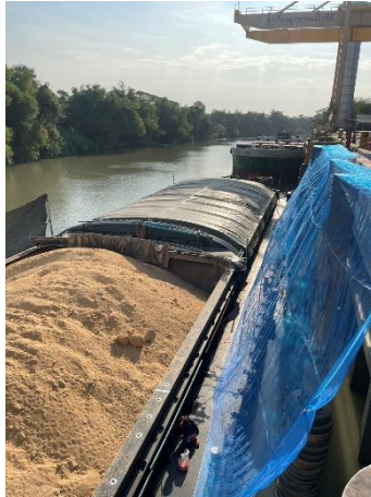
รูปที่ 1 การชิงผ้าใบหน้าผ้าพลาสติกระหว่างเรือลำเลียงสินค้าและท่าเทียบเรือ
