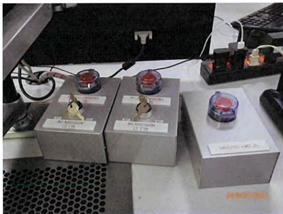
ภาพที่ 2.2-38 Emergency Switch
