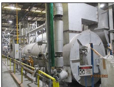
รูปที่ 2-3 Dust Collector
