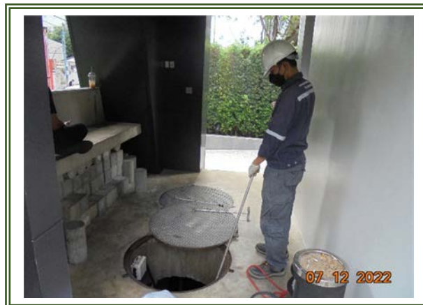
รูปที่ 3-7 คุณภาพน้ำทิ้งก่อนการบำบัด บริเวณบ่อปรับสภาพน้ำพร้อมตะแกรงดักขยะ
