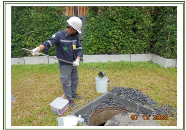
รูปที่ 3-6 คุณภาพน้ำทิ้งหลังการบำบัด บริเวณถังสูบน้ำทิ้ง
