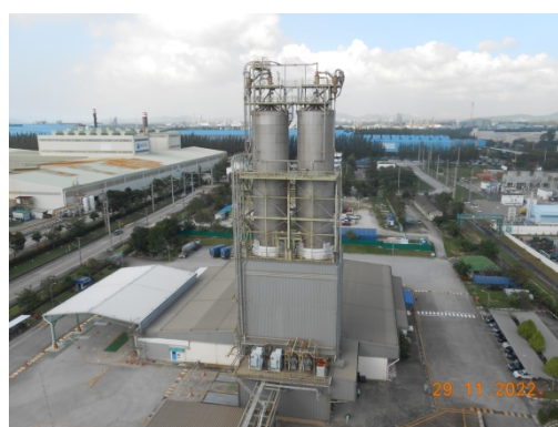
รูปที่ 6 Cyclone ชุดที่ 3 และ 4 (MC-1614 และ MC-1624)
