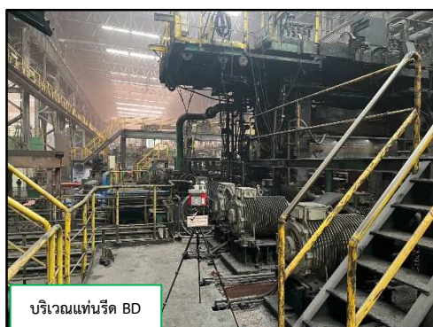
ภาพที่ 3.40 การตรวจวัดความร้อนในสถานที่ทำงานบริเวณแท่นรีด BD
