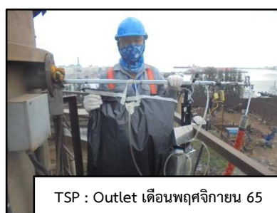
ภาพที่ 3.6 การตรวจวัดคุณภาพอากาศจากปล่อง Baghouse
