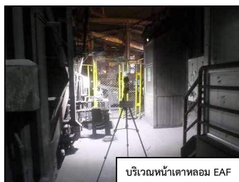
ภาพที่ 3.38 การตรวจวัดเสียง Leq 12 ชั่วโมง บริเวณหน้าเตาหลอม EAF
