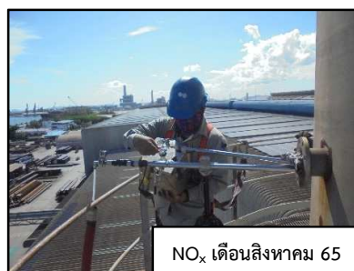
ภาพที่ 3.6 การตรวจวัดคุณภาพอากาศจากปล่อง Baghouse
