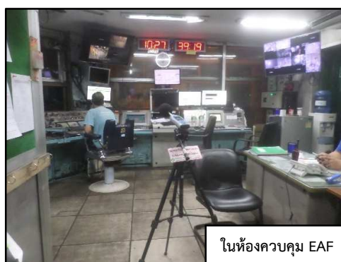
ภาพที่ 3.38 การตรวจวัดเสียง Leq 12 ชั่วโมง บริเวณหน้าเตาหลอม EAF
