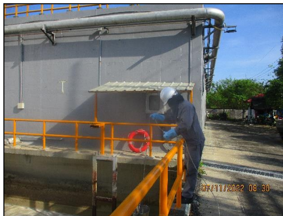
รูปที่ 4.27 การเก็บตัวอย่างน้ำทิ้งจากระบบบำบัดน้ำเสียแห่งที่ 2 (Sequencing Batch Reactor) บริเวณ Influent
