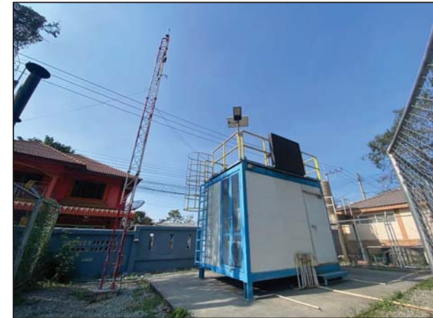
ภาพที่ 2.1 สถานีตรวจวัดคุณภาพอากาศในบรรยากาศแบบต่อเนื่อง โรงพยาบาลส่งเสริมสุขภาพตำบลมายางพร (A5)
