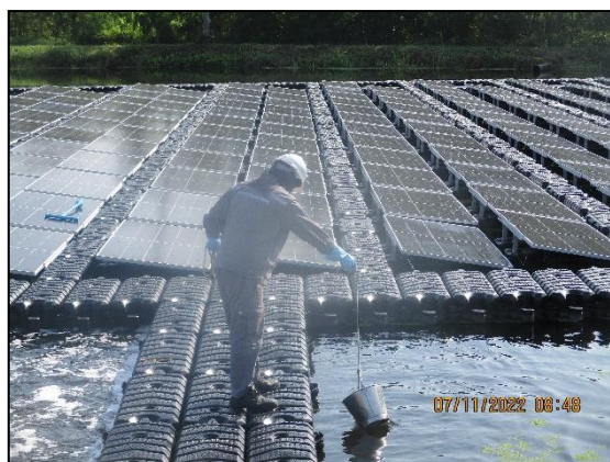
รูปที่ 4.31 การเก็บตัวอย่างน้ำทิ้งหลังจากระบบบำบัดน้ำเสียส่วนกลางทางชีวภาพ บริเวณ บ่อ Holding Pond แห่งที่ 1
