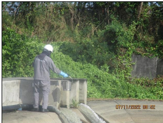
รูปที่ 4.26 การเก็บตัวอย่างน้ำทิ้งจากระบบบำบัดน้ำเสียแห่งที่ 1 (Activated Sludge) บริเวณ บ่อ Equalization Tank
