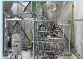
ระบบกักเก็บและป้องกันการฟุ้งกระจายของคาร์บอนแบล็ก
