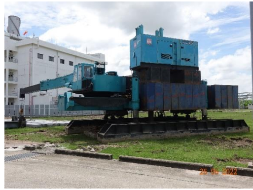
(14) เครื่องยกเสาเข็มระบบไฮดรอลิก
