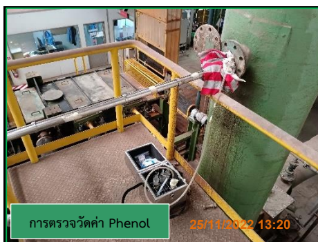
ภาพที่ 3.4 การตรวจวัดคุณภาพอากาศจากปล่อง EPL Plating (สายผลิตที่ 1)
